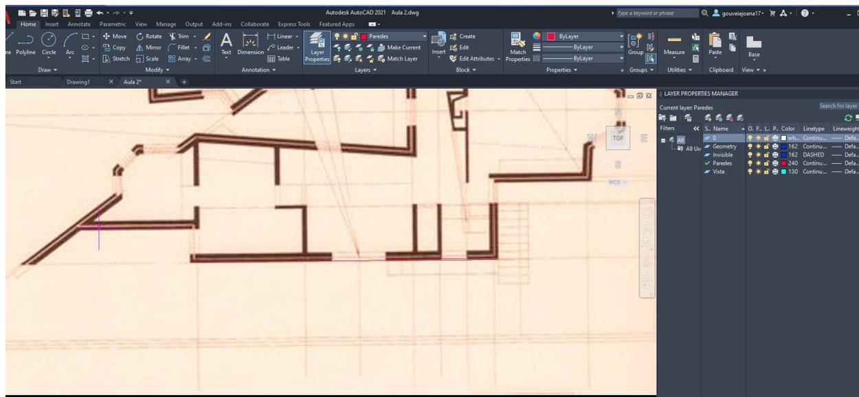
Ao colocar a imagem no AutoCad através do ATTACH, foi preciso alinhá-la com uma linha que fiz usando o comando ALign. A partir dessa linha inicial, foi só começar a fazer paralelas para formar as paredes.
